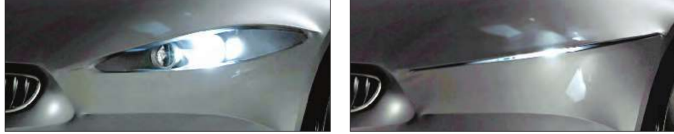
ميزة الأضواء الأمامية أنها تنغلق عندما لا تكون في حال التشغيل والأضواء الخلفية لا يظهر منها سوى الضوء عندما يطلب منها السائق ذلك.
