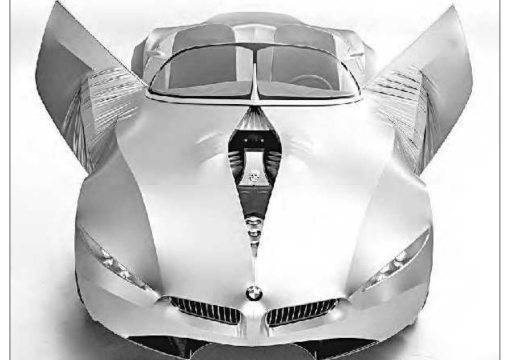
يفتح غطاء السيارة الأمامي من المركز حيث تتباعد أجزاء النسيج للكشف عن أجزاء المحرك
