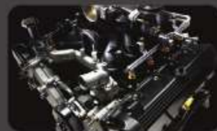
محرك V8 سعة 5.4 لتر 24 صمام مع خاصية نظام التبريد الجاف
