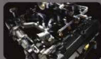
محرك V8 سعة 5.4 لتر 24 صمام مع خاصية نظام التبريد الجاف
