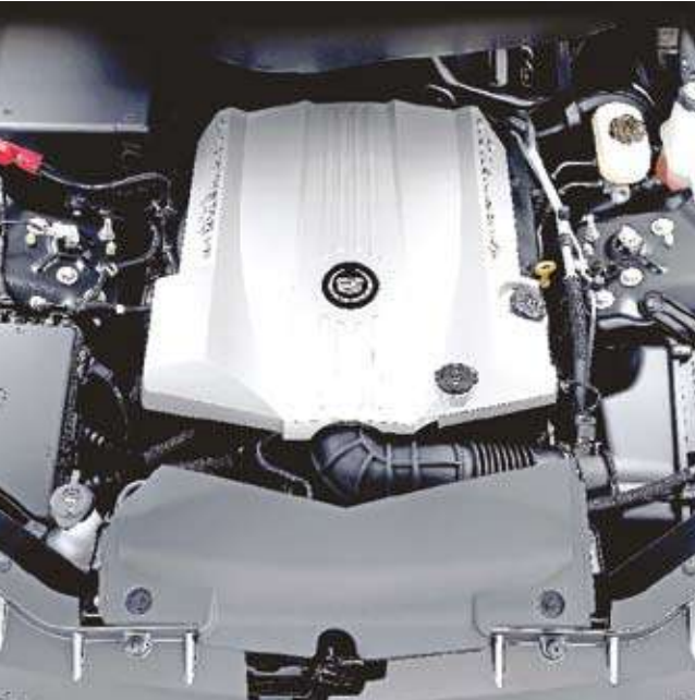
محرك متطور من طراز «نورث ستار» يتألف من 8 اسطوانات على شكل V تبلغ سعته 4.6 ليترات، ويولد قوة 320 حصاناً عند 6400 دورة في الدقيقة
