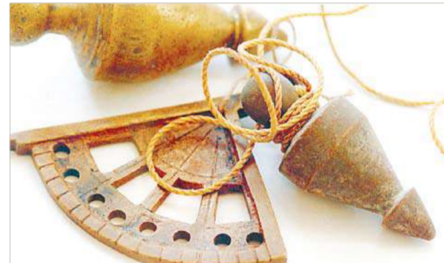
الهنداسة: آلة على شكل ربع دائرة بها خطوط لتحديد القياسات، أما النقل النحاسي المعلق بها، فهو لتحديد مقدار الزاوية، أو درجة ميلان العمود في السفينة
